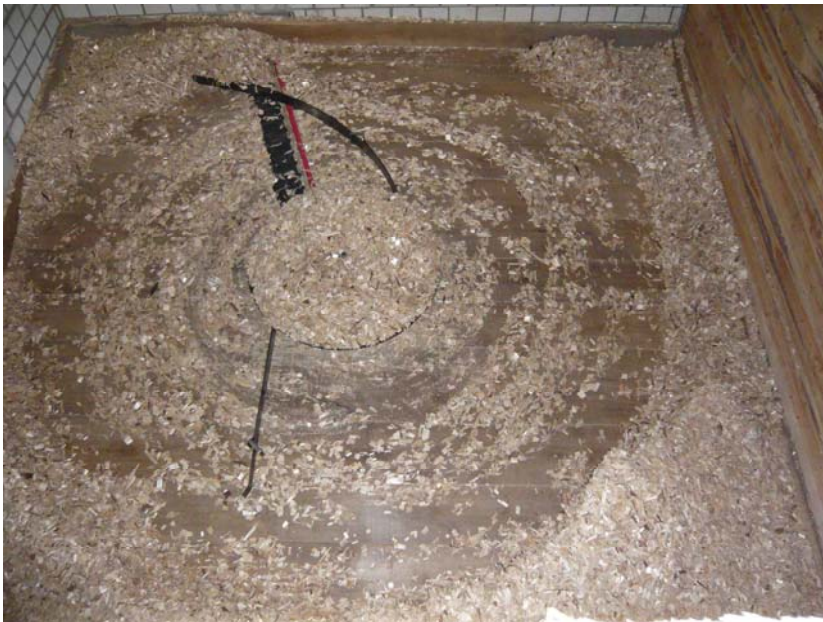
Die Förderschnecke der Anlage.
